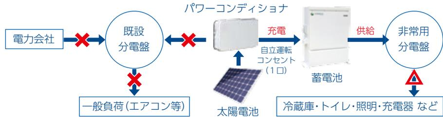
※パワーコンディショナは停電になると分電盤への出力を停止し、自立運転コンセントからの出力に切り換わります。
